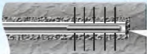
Укрепленный цементом корпус трубы уменьшает выброс газа и снижает возможность загрязнения воды
